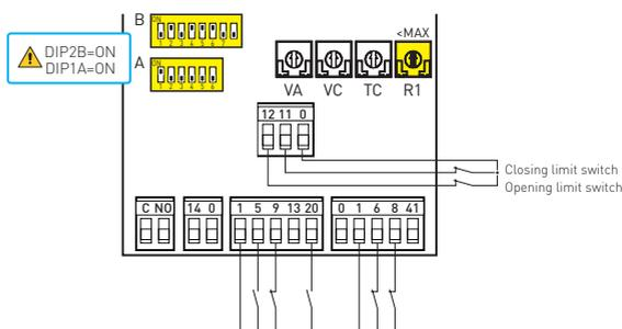
**(Exemple 2).** On peut utiliser la commande radio avec fonctionnement pas-à-pas en même temps que la borne 5 avec fonction d'ouverture en effectuant les raccordements indiqués et en réglant DIP1A=OFF.
