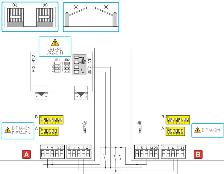
Il est possible de commander deux automatismes [A] et [B] en parallèle, en faisant les raccordements et les réglages indiqués dans la figure.
